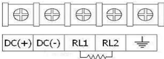
(图 3.5) 高端型制动单元端子排列
