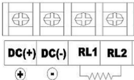
(图 3.4) 通用型制动单元端子排列
