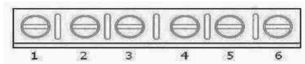
(图 4.4) 高端型产品主从并连接线端子
