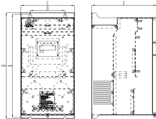
(图 2.4) 高端型制动单元的外形及尺寸
