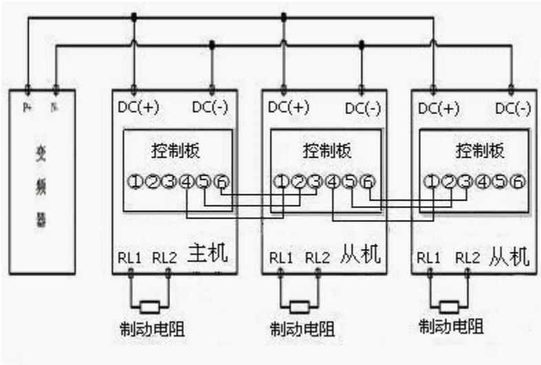
(图 4.2) 高端型产品并联接线图
