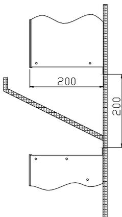
(图 3.2) 两台制动单元上下安装示意图
