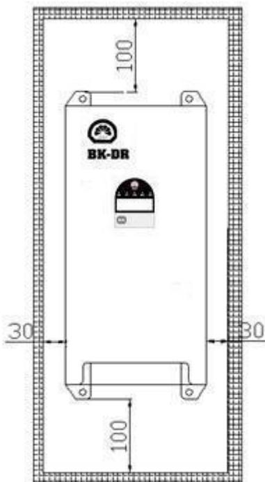
(图 3.1) BKBU 系列制动单元的安装空间要求
