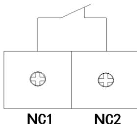
(图 3.7) 经济型故障保护触点示意图
