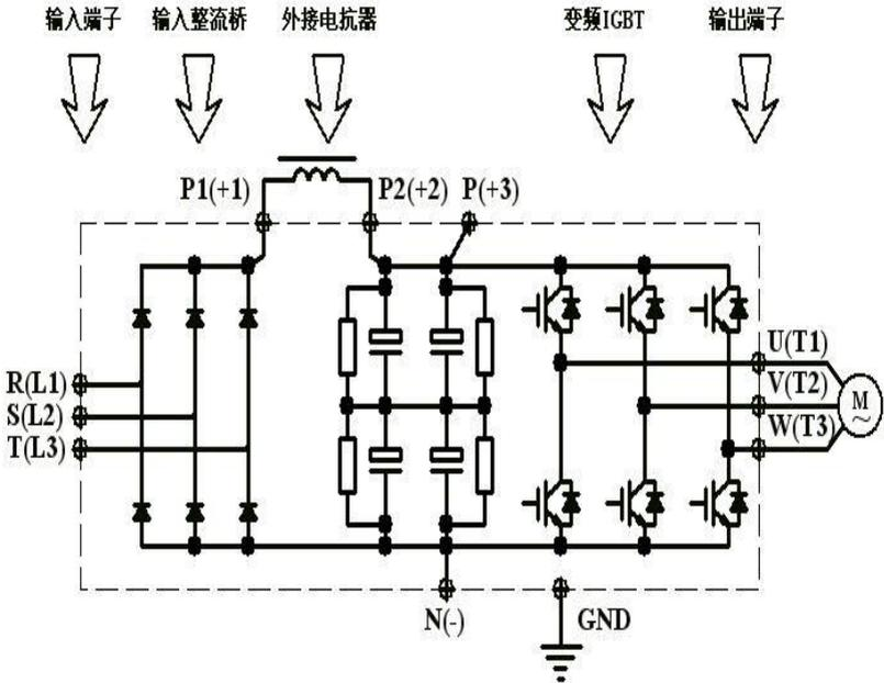
(图 3.9) 常用的变频器主回路接线端子
