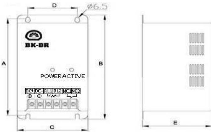
(图 2.3) 通用和经济型系列制动单元的外形及尺寸
