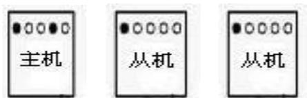
(图 4.3) 高端型产品并机时主从工作灯指示状态
