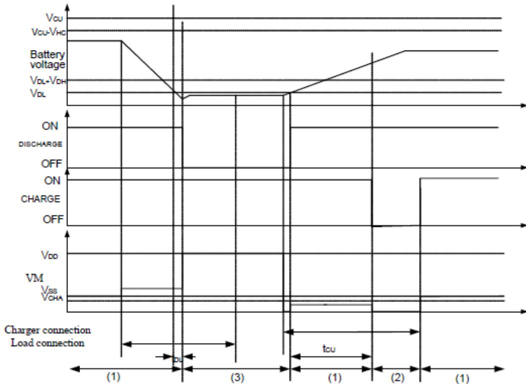
备注：(1) 正常工作状态 (2) 过充电电压状态 (3) 过放电电压状态 (4) 过电流状态
