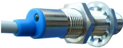
WB-JS033 是我司生产的磁控开关，是一款通用小型小功率常开接近式磁性开关。不锈钢外壳带螺纹螺丝可锁式安装。磁感应区在开关的顶部。该开关可以用电磁控制，也可用永磁铁控制，或是两者的结合。轻松实现无接触控制。线材、接线端子、引线的长度及控制距离均可应客户要求定做。
