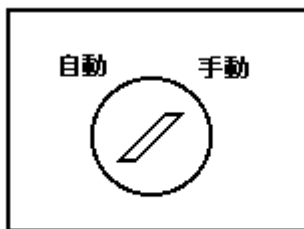
圖14: 自動/手動鑰匙開關處於手動狀態
