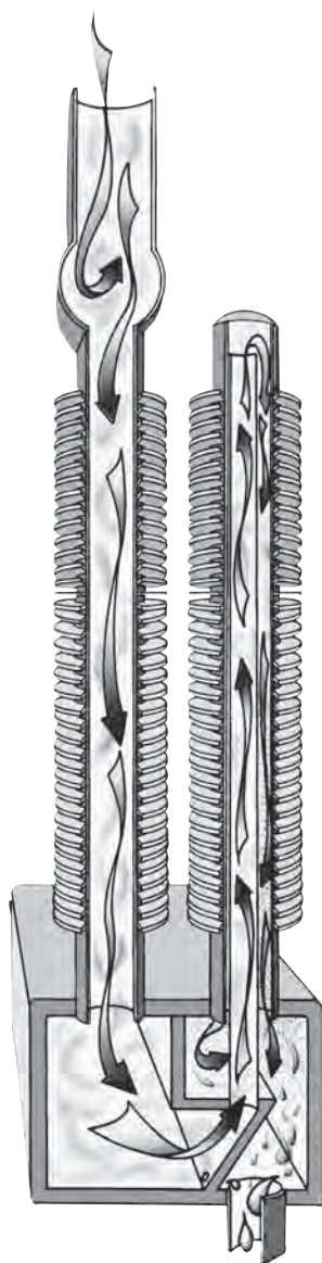
T型盘管的接管在两侧
