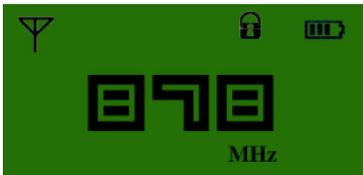
1. 开启开关进入接收状态，显示当前接收的频段 8 7 8 MHz
