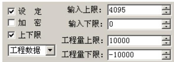
这样，当寄存器中输入 A/D 转换值时，就可以显示电压值了。
