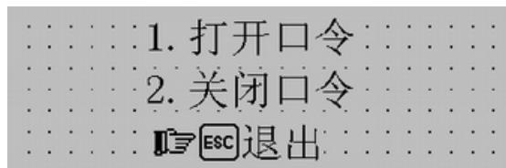
用上下键和 ENT 键选择。选择 1，执行打开口令操作；选择 2，使系统处于口令关闭状态；按“ESC”键，退回监视状态。
