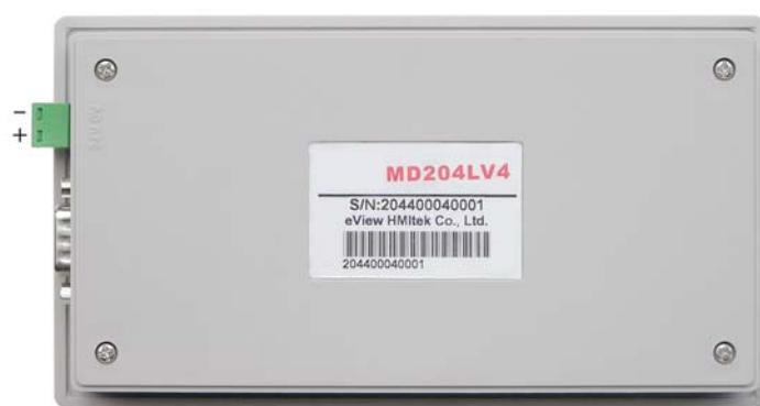
产品背面的左侧为外接 DC 电源端子和 9 针 D 型公座的通讯端口，RS232、RS485 和 RS422 通讯端口都是置于 9 针 D 型插座中，下载画面数据时，使用通讯电缆 MD2-PC 将 MD204L 的 9 芯通讯口和个人计算机的 9 芯通讯口连接起来，和 PLC 通讯时，根据 PLC 机型确定通讯口连接方式（在组态软件中设定）。
