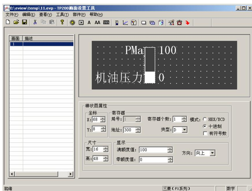
该棒形图监视 D300 中的数据，当棒形图满刻度显示时，表示 D300 中的数据为 100；当棒形图 50%刻度显示时，表示 D300 中的数据为 50。
