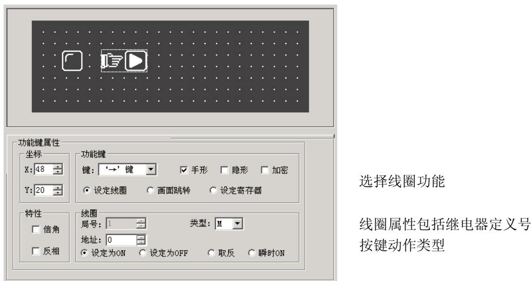
在功能栏中，选择“SET”键作为自动模式设定按键。将继电器定义号设定为 M10，选择动作模式设定为 ON.为了简明显示，取消手形显示。
