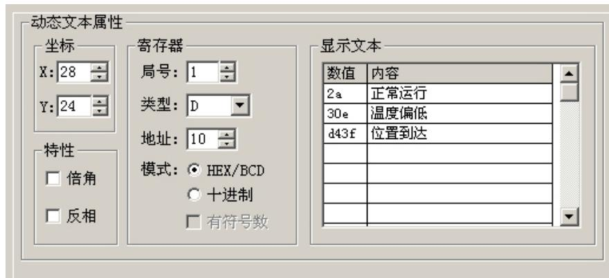
例：如图显示 D10 控制的动态文本，显示文本有三个状态“正常运行”“温度偏低”和“位置到达”分别对应的 D10 寄存器值为 16 进制数 2a, 30e, 和 d43f。在显示文本设定中第一条数值栏输入“2a”，右侧内容中输入“正常运行”四个字，依次输入其它两条。当 D10 的数值为 2a 时，文本显示为“正常运行”，当值为 30e 时显示“温度偏低”，其余依此类推。
