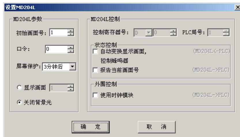
输入口令或修改原口令，例：输入密码“**5678**”，按“确定”，口令被确认。
