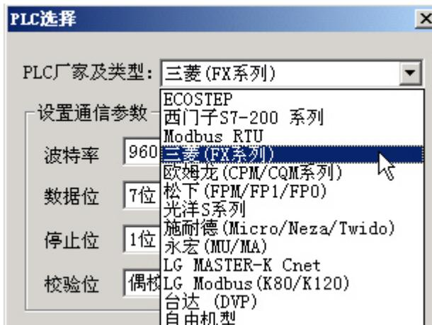
在这个窗口选择了正确的 PLC、波特率、数据位、停止位和校验位。
