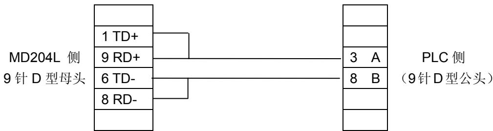
(推荐采用 S7200 编程电缆进行通讯，直接将编程电缆接 PC 端那个头改接到 204L)
