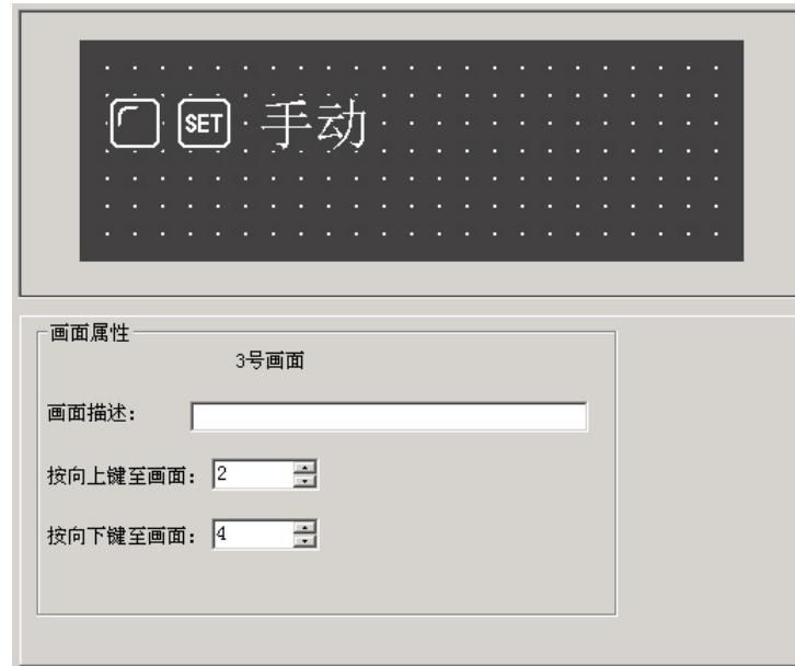
以同样方法设置手动按键，手动状态指示灯。指示灯的地址仍然对应 M10，显示属性取负逻辑。
